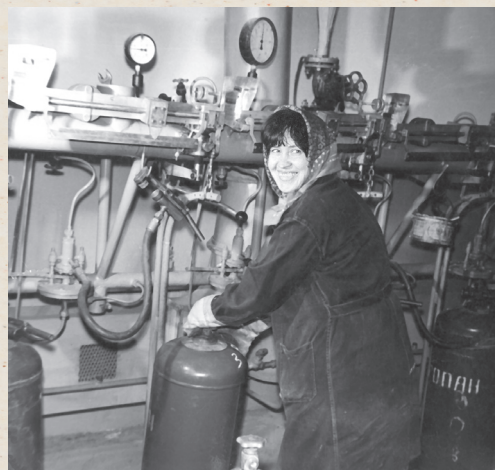
Заправка газовых баллонов.
